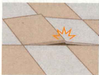
床タイルの浮き
